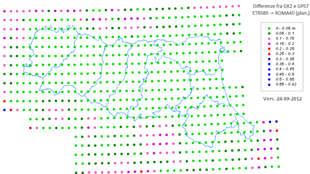
Differenze fra GPS7 regionale e GK2 nazionale per il passaggio fra ETRS89 e ROMA40 (planim.)
