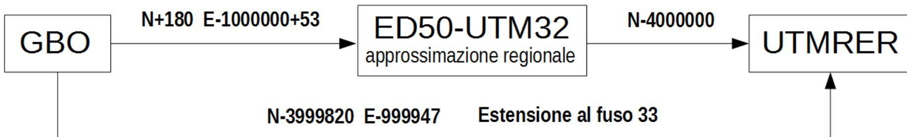
Il sistema UTMRER negli anni è stato denominato con diverse modalità: UMT32\*, che stava per ED50-UTM32(\*) ovvero "con falsa origine nord, esteso al fuso 32", oppure UTMA (dove A sta per Asterisco).
