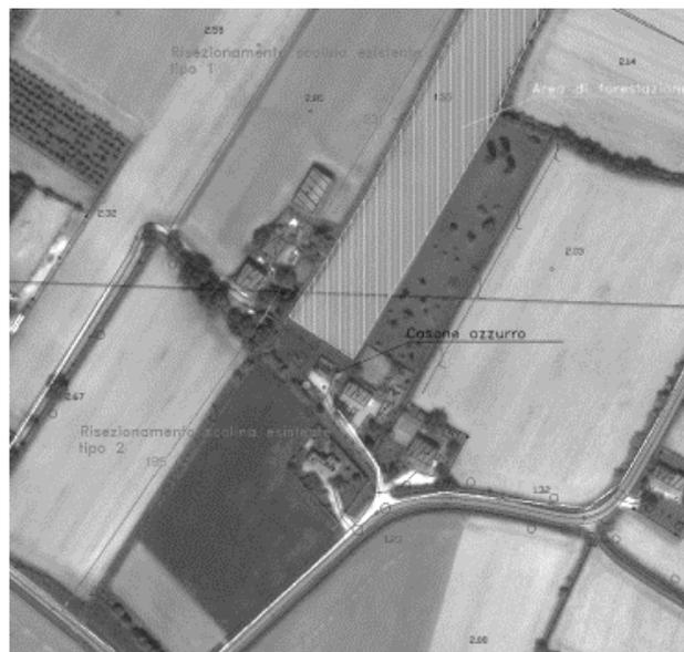
Fig. 5 – Esempio di progetto di area forestale di laminazione su ortofoto.
